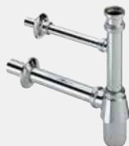
Búraszifon - krómozott sárgaréz Kialakítás/felszereltség Ø 50 tányér, állítócsavarzat, csatlakozó szívárgó vízhez, 160 mm-es állítócső, 250 mm-es lefolyócső DIN EN 274 minőségellenőrzött modellszám 5753.02
