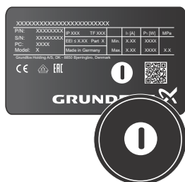
36. ábra Azonosítsa a főszivattyút az adattáblán
