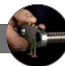
Embutir el extremo del tubo con el pistón
